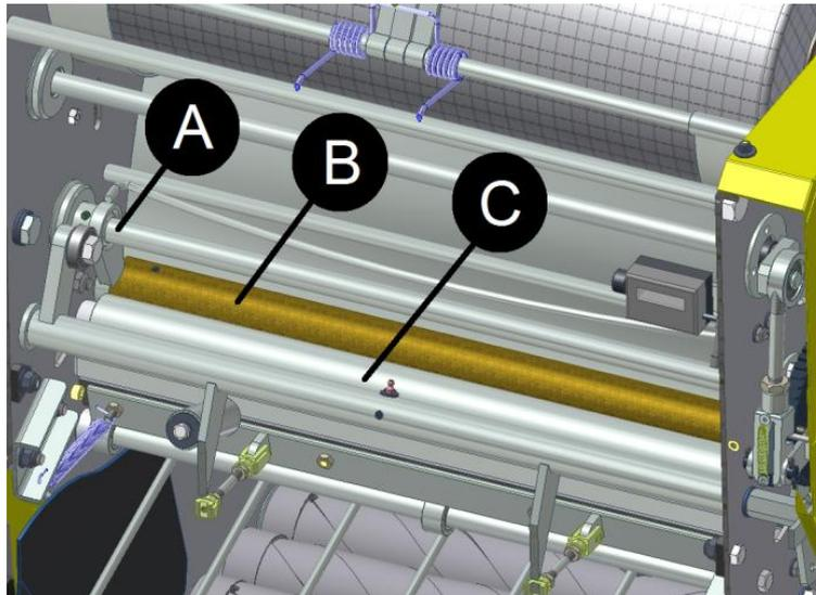
Abb. 195 Antriebsrollen in den Leerlauf versetzen
