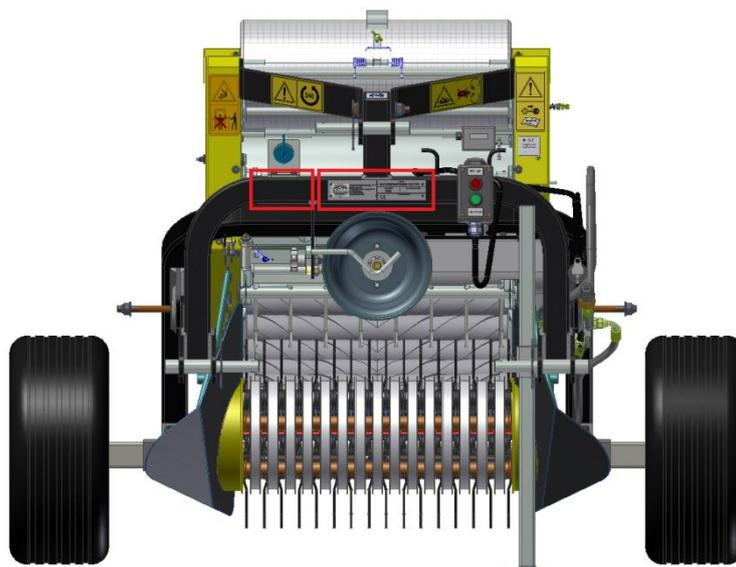
Abb. 2 Position der Schilder und Seriennummer auf dem Fahrgestell
