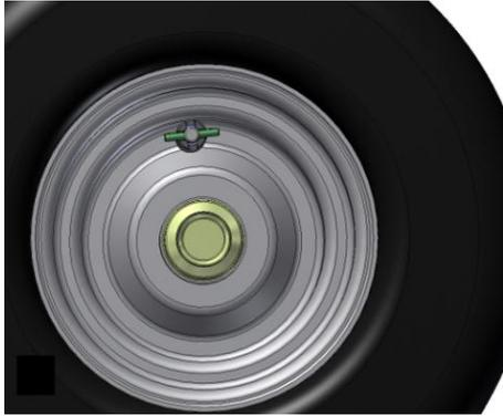
Abb. 242 Feststellbremse ausgekuppelt
