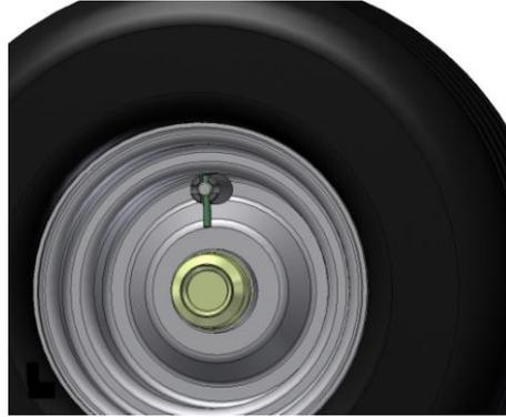
Abb. 253 Feststellbremse
