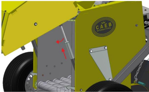
Abb. 2 Schließsicherung
