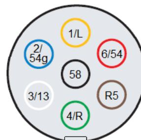
Abb. 308 Anordnung der Kontakte im 7-poligen Stecker
