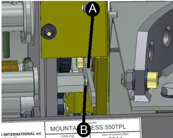
Abb. 101 Einstellhebel A, Fixierzapfen B
