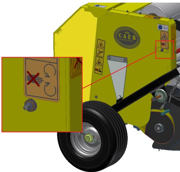
Abb. 173 Mutter der Bindungsbremsscheibe
