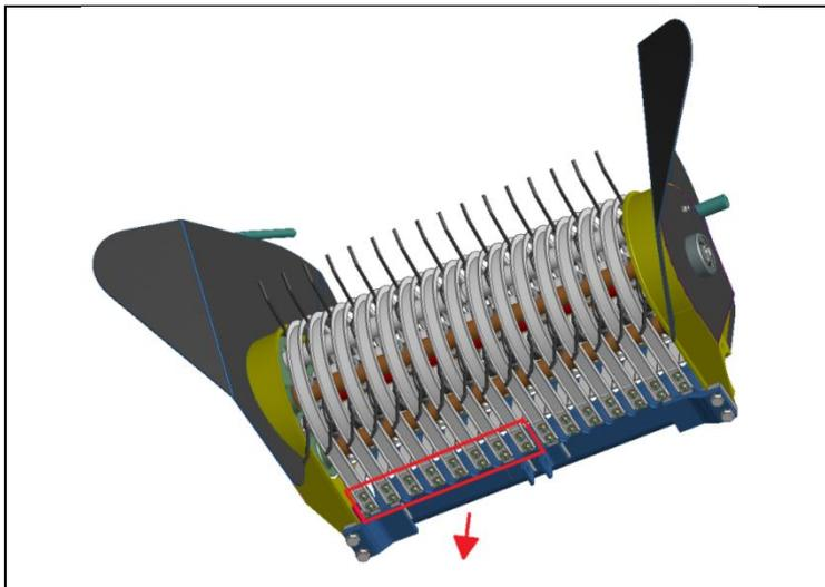
Die unteren Befestigungsschrauben der Pick Up Bänder an der Seite abschrauben, an der die beschädigte Feder auszuwechslern ist.
