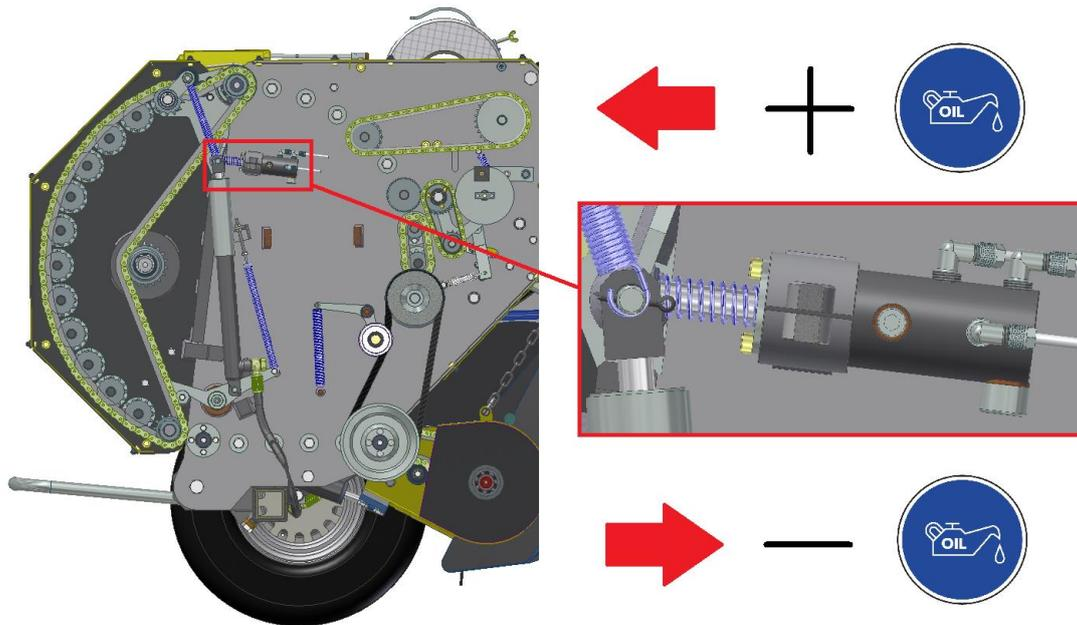
Abb. 29 Einstellung der Schmierpumpe
