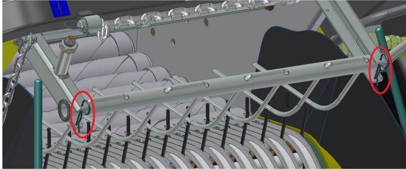
Abb. 16 Position der elastischen Splints des Förderrechen
