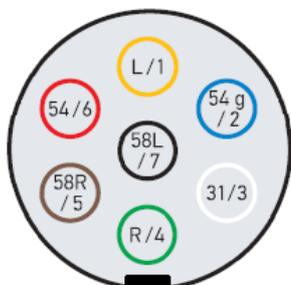
Abb. 297 Anordnung der Steckdosenkontakte Typ 12N
