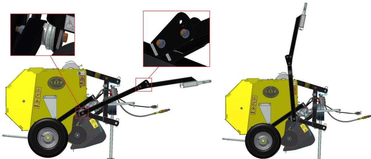
Abb. 26 Elemente der Verstellung des Schleppens.
