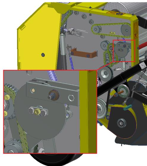
Abb. 184 Freno legatura Bindungsbremse
