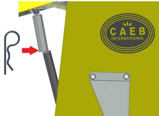
Abb. 3 Feststeller der Schließsicherung
